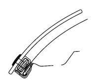
14. Épluchez et pliez deux (2) des garnitures antiabrasion de film dans la moitié au-dessus du bord de capot aligné avec les trous intérieurs du protecteur dans le secteur au-dessus des phares.
