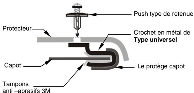
6. Installez les deux (2) supports en métal de **Type 4b** sur le bord de capot, sous le protège capot, en alignant la branche du crochet avec le trou dans le trou sur le capot. Installez deux (2) - assemblages de chevilles d'expansion à travers les supports dans le trou sur le capot; Insérez et serrez les vis n° 6 x 1/2 po. **Ne pas trop serrer la vis.**
