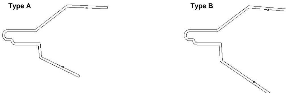
4. Installez braquet en métal **type A** à la bonne endroits sur le capot de pointe, alignant la branche du crochet avec le trou dans le trou sur le capot. Ajouter un type de retenue pousser par l'intermédiaire du support métallique et dans le capot. Assurer la jambe de support est bien assis contre la surface du capot, et pousser la broche centrale de la bague de retenue ASSY pour l'enclencher. Voir l'illustration.
