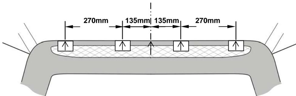
4. Installez le bouchon d'expansion se branche sur le haut du dos adhésif piédestaux. Utilisez le centrage encoche sur le piédestaux de l'aligner sur la position de la marque de crayon sur la bande lors de la précédente étape.
