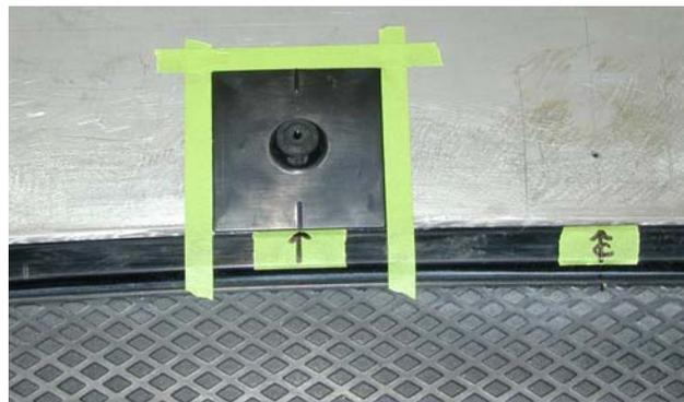
5. Temporairement les piédestaux de bandes à la surface du capot, déterminée dans leurs positions, confirmer placement correct en plaçant le capuchon protecteur au-dessus des quatre piédestaux. Lorsque positionné correctement les quatre (4) trous dans la zone centrale de la volonté aligne protecteur avec les trous dans bouchon l'expansion. Ajustez si nécessaire, et réaffirmer le piédestaux emplacements en utilisant les mesures effectuées dans l'illustration et le capot protecteur.
