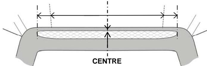
3. **Installer les (4) butées** sur le capot tel qu'indiqué à l'illustration. **Attention: Les butées doivent être installées sur le capot et non sur le protecteur!!!** Si les butées sont installées sur le protecteur, elles useront la peinture. - *Voir l'illustration.*
