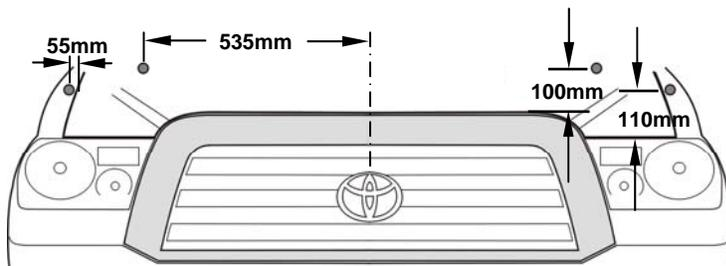
9. Placez le capot protecteur sur le capot et fixez-le (4) n° 8 x 7/16 po. treillis vis à tête à travers le protecteur et à l'expansion des bouchons. **Ne pas trop serrer.**
