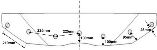
3. Peler et plier les tampons anti-abrasifs buvards à moitié sur le bord du capot, dans les guatre (4) endroits indiqués. Centre du film pads avec des trous identifiés dans l'illustration.
